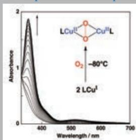
銅(I)錯体と分子状酸素を-80℃で混合し、紫外可視分光光度計で測定した時の吸収スペクトル変化。2核銅(II)ペルキオ銅錯体の生成の様子が時間分解スペクトルにより確認できる。
