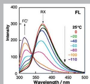
ペンタン溶液中における(R)-1-メチルヘプチルメリテートの紫外・可視吸収及びCDの温度依存スペクトル。0.03mM。ペンタン溶液中における(R)-1-メチルヘプチルメリテートの蛍光の温度依存スペクトル(25℃～-110℃)。励起波長は270nm。
