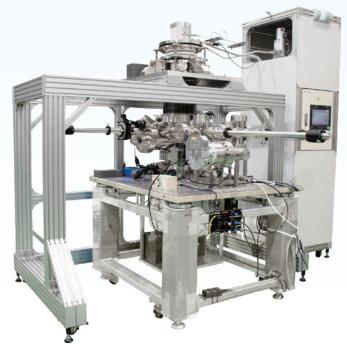
機械式冷凍機で6K以下の原子分解能STMを実現希少な液体へリウムを使用せず、長時間の連続冷却
