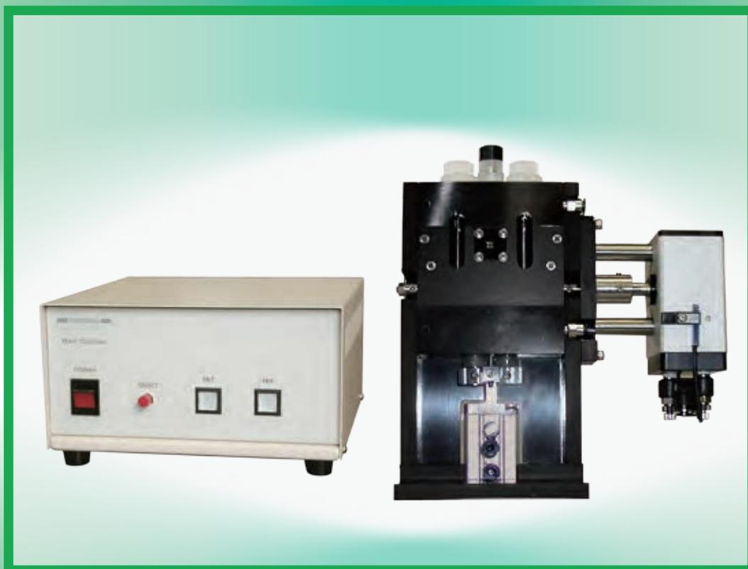
ストップフロー測定を、放射光施設(特に小角錯乱ビームライン)や市販の円二色性分光装置において測定できるように光路方向を薄型に設計したストップとフロー装置です。蛋白質のフォールディング実験にも利用でき、混合効率は他社の追随を許しません。専用コントローラにより、コック切り替え、ミキシング開始などを手動制御外部制御にて行えます。用途に合った観測セル、ベースアダプタなどをご用意いたします。
