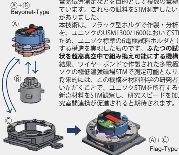
材料科学研究で使用される試料作製・分析装置では、フラッグ型試料ホルダが主流となっており、一般的に電気伝導測定などを目的として複数の電極が備えられています。これらの試料をSTM測定したいという要望がありました。本技術は、フラッグ型ホルダで作製・分析された試料を、ユニソクのUSM1300/1600においてSTM測定するため、ユニソク標準の6電極試料ホルダとしても機能する構造を実現したものです。ふたつの試料ホルダ形状を超高真空中で組み換えることができる機構を導入した結果、ワイヤーボンドで作製された多電極試料もユニソクの極低温強磁場STMで測定可能となりました。将来的には、この機構を材料科学の研究者に採用していただくことで、ユニソクSTMを所有するグループが新奇材料をSTM観察し、研究スピードを加速させる研究室間連携が促進されると期待されます。
